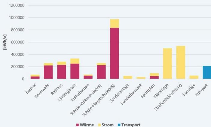
Abbildung 9 zeigt den Energieverbrauch der Gemeindegebäude und Anlagen, gegliedert nach Wärme, Strom und Transport. Als bedeutendste Großverbraucher lassen sich die Hauptschulen, Kläranlage und Straßenbeleuchtung identifizieren.
